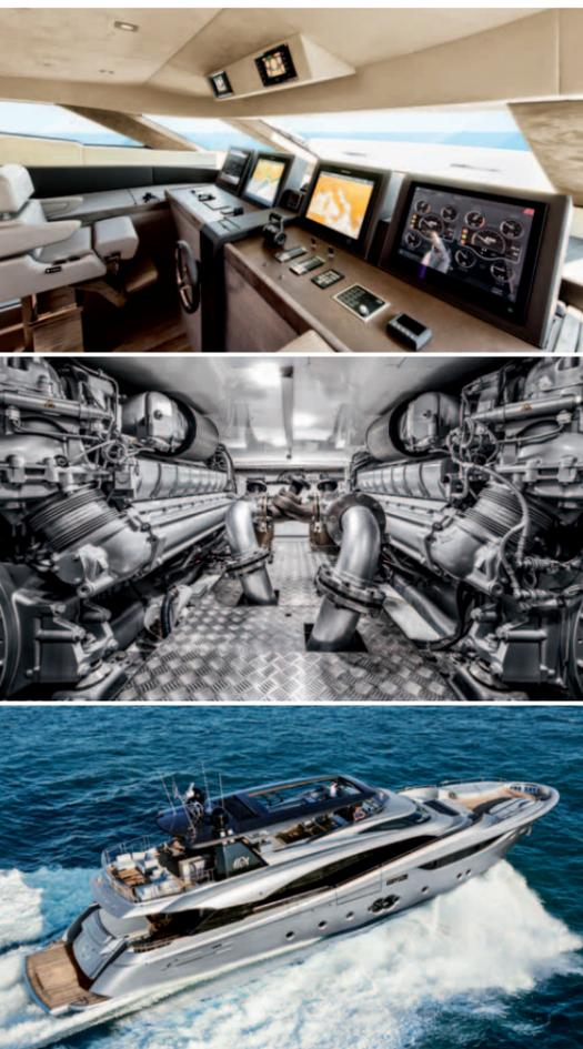
Schaltzentrale: Von der Brücke aus regiert der Kapitän über die zwei kräftigen MAN-Diesel mit je 1815 Kilowatt Leistung.
