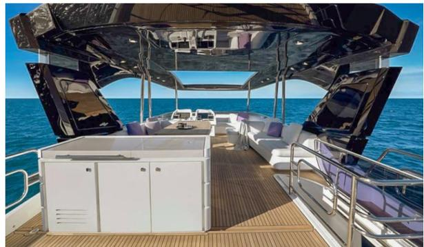
Protégé par un précieux T-Top en carbone, il donne au yacht un grand salon en plein air supplémentaire, offrant une vue à 360 degrés qui, si nécessaire, peut s'amplifier en ouvrant électriquement le toit coulissant.
